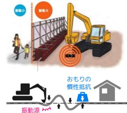
おもりによる振動抑制工法の概念図
