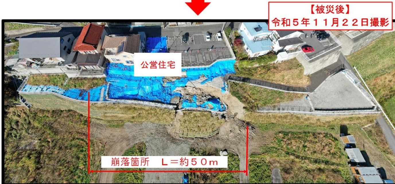
【唐丹町小白浜地区】漁具置場擁壁崩落現場 被災状況写真
