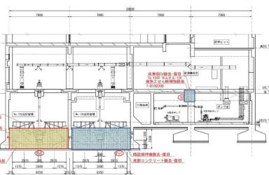
汚泥処理棟地階断面図A-A
