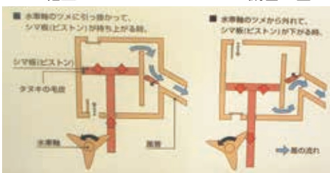
箱型フイゴの仕組み
