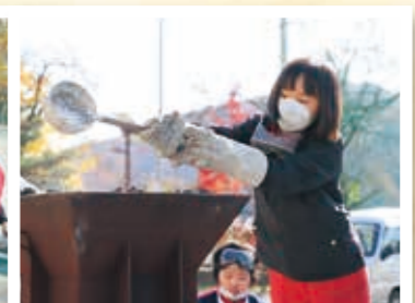
鉄鉱石と石灰を混ぜた原料を炉の上部から投入します
