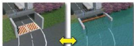
防波堤開口部・3方水密の例(平成27年度設置決定)
