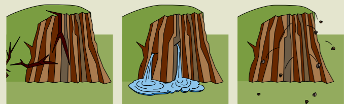
がけに割れ目が見える がけから水が湧き出ている がけから小石がぱらぱら落ちてくる
