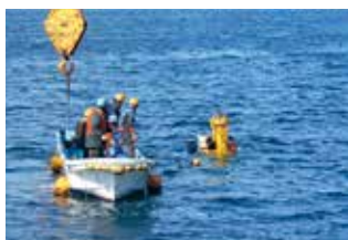
上：製作した模擬波力発電装置（低コスト中間プイ）全長11m、約3t 下：水深29mで行われた第2回海洋予備試験（3月24日）
