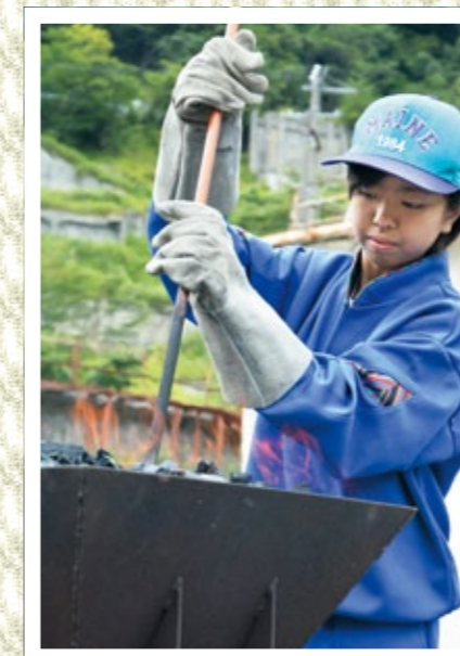
炉内の詰まりを取って木炭を下に落とすしていく
