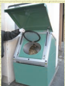
ホテルサンルート釜石で使用している生ごみ処理機
